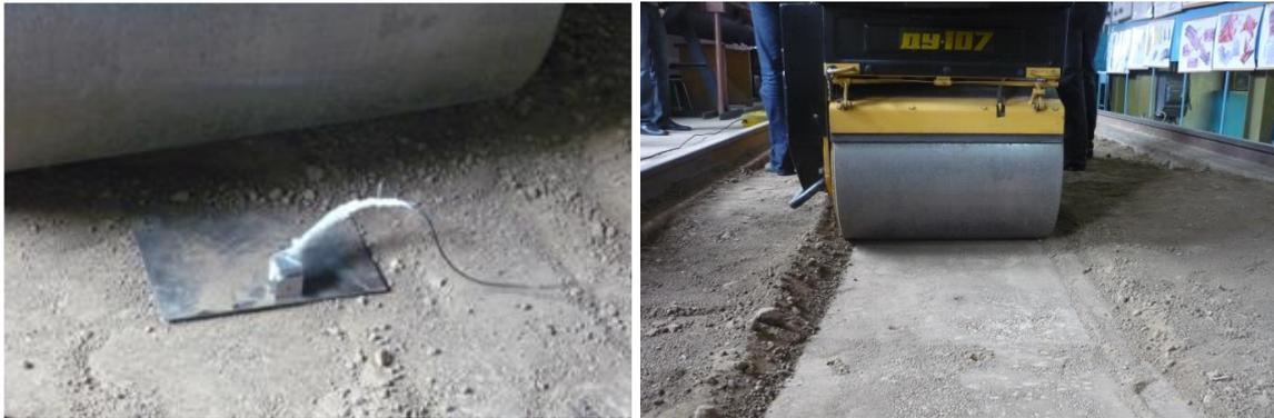
Рисунок 1 - Изучение тенденции распространения вибрации на поверхности уплотняемого грунтового слоя
