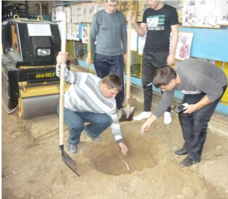
Рисунок 3 - Определение тенденции распространения виброволн в вертикальной плоскости
