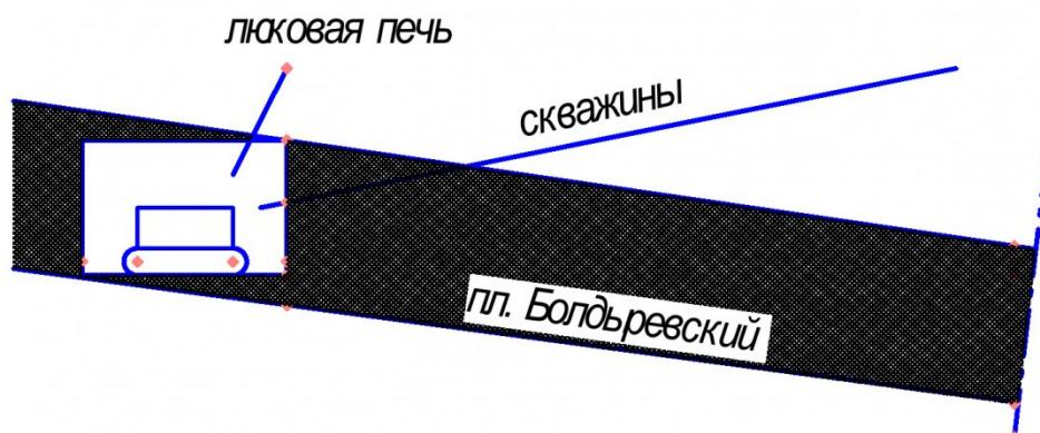
Рис. 1. Схема бурения скважин в кровлю пласта Болдыревский
