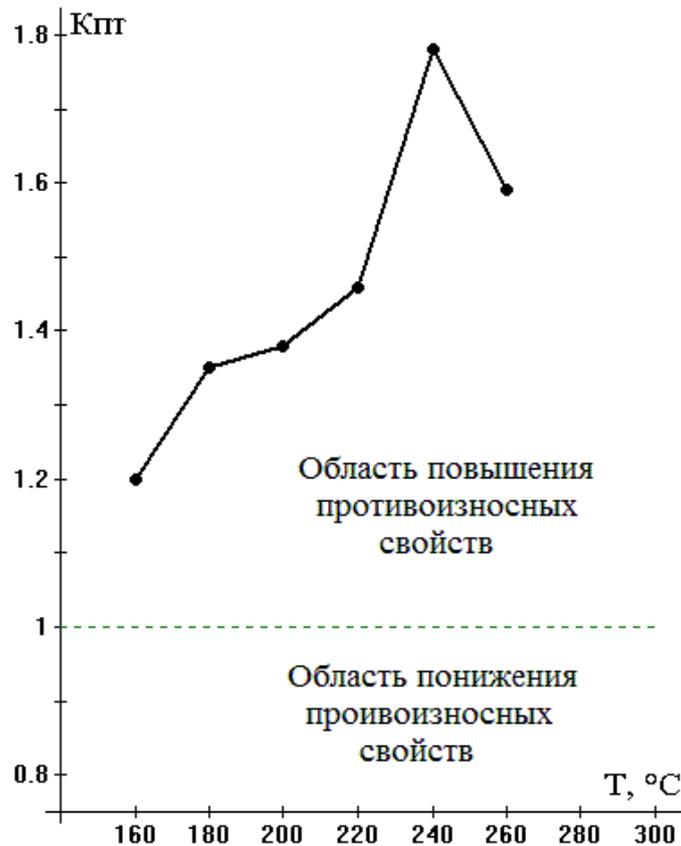
Рис. 5. Зависимость коэффициента влияния предварительного термостатирования синтетического моторного масла Mobil Super 30005W-40 SJ/SL/SK/CF от температуры термостатирования
