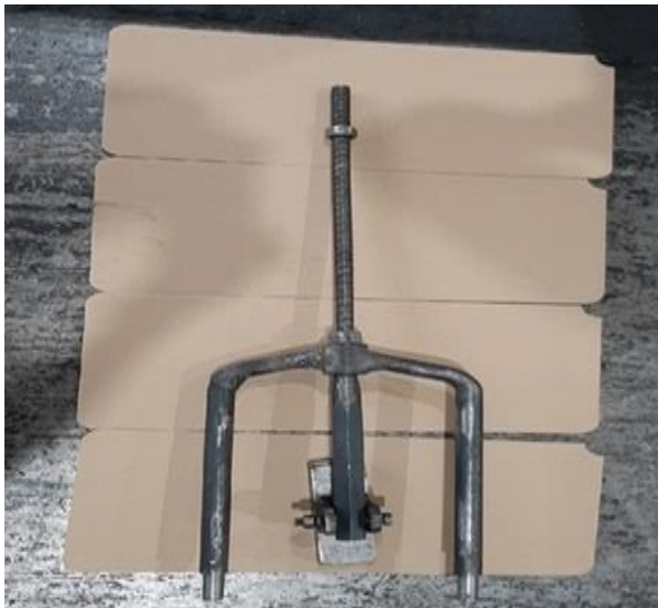
Рис. 2. Приспособление для демонтажа гильз цилиндра
