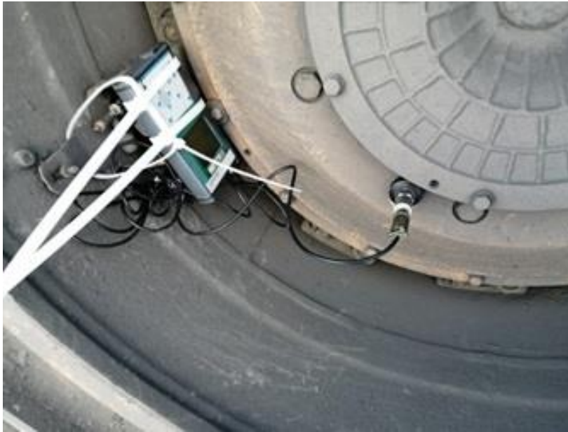
Рис. 1. Способ крепления прибора «Диамех 2000» на обод колеса Fig. 1. Method of fixing the device "Diamekh 2000" to the wheel rim
