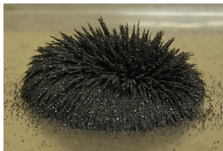
Рис. 1. Характерное образование «ежика» при воздействии магнита на магнетит Fig. 1. The characteristic formation of a "hedgehog" when a magnet acts on magnetite
