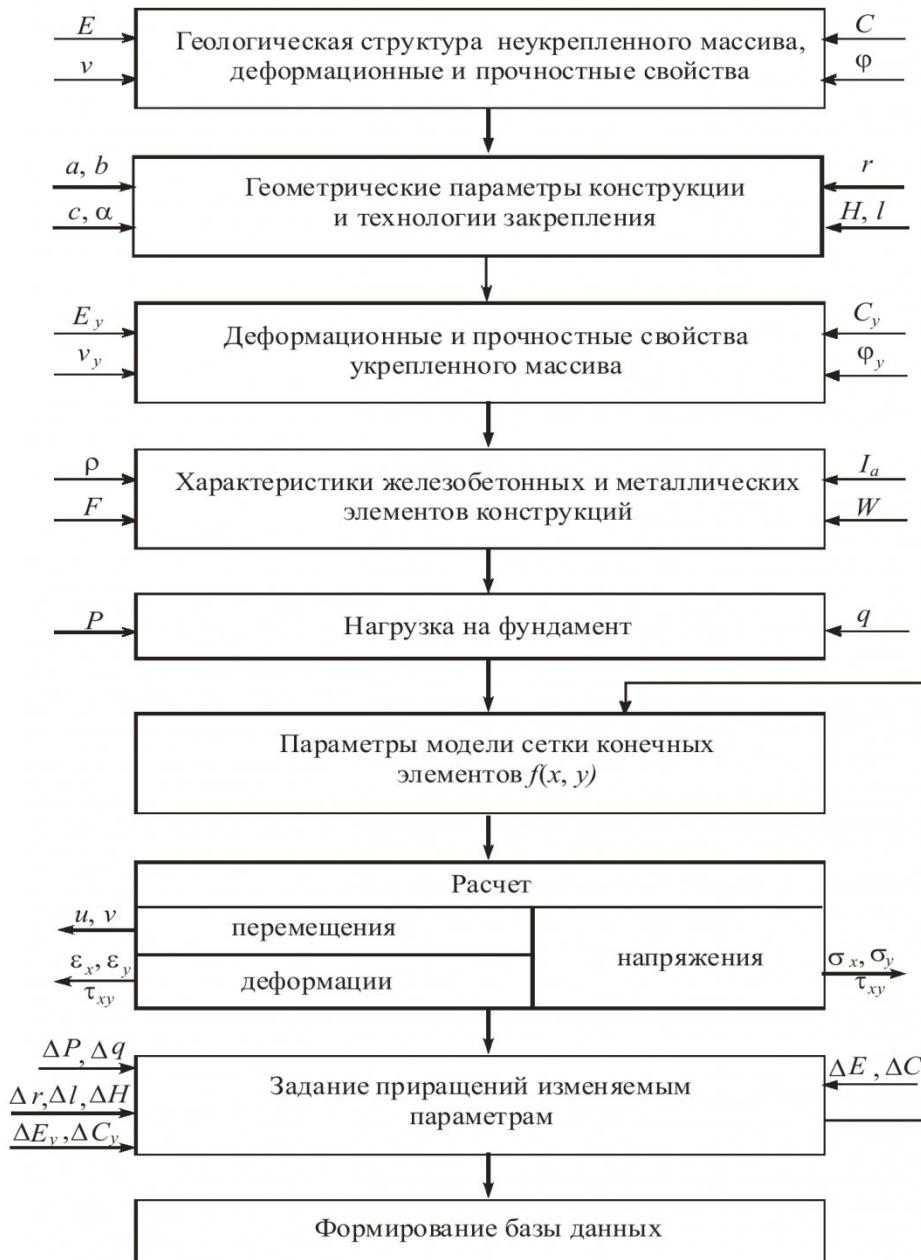
Рис. 2. Укрупненный алгоритм моделирования
