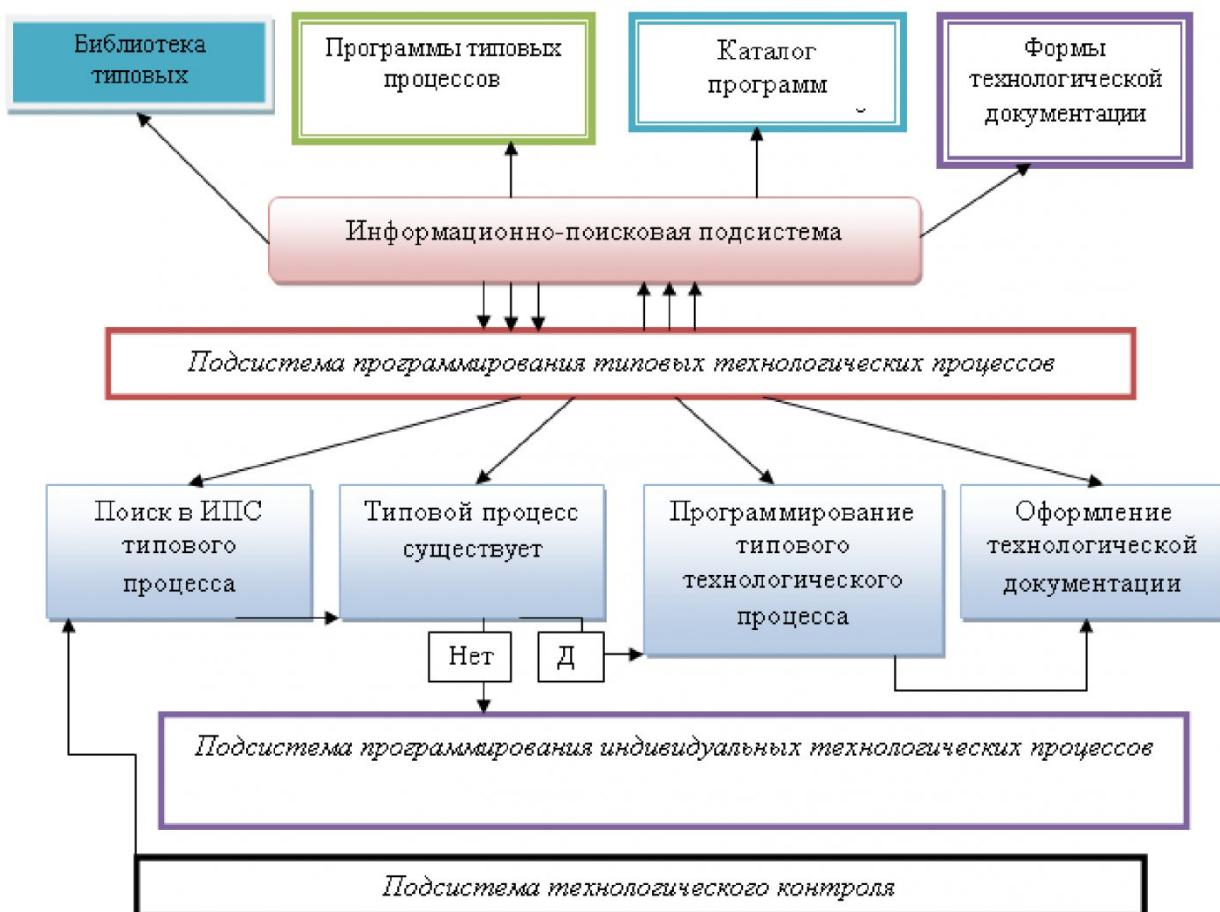
Рис. 2 Схема автоматизированной подсистемы программирования типовых технологических процессов
