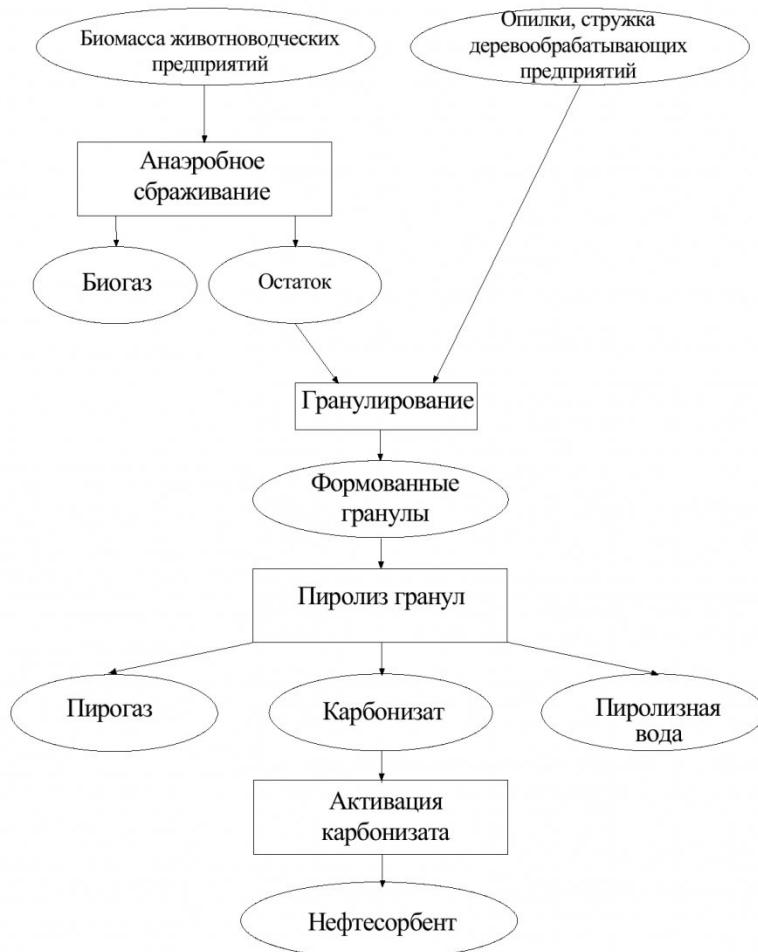
Рис. 1. Схема получения нефтесорбента из вторичного сырья
