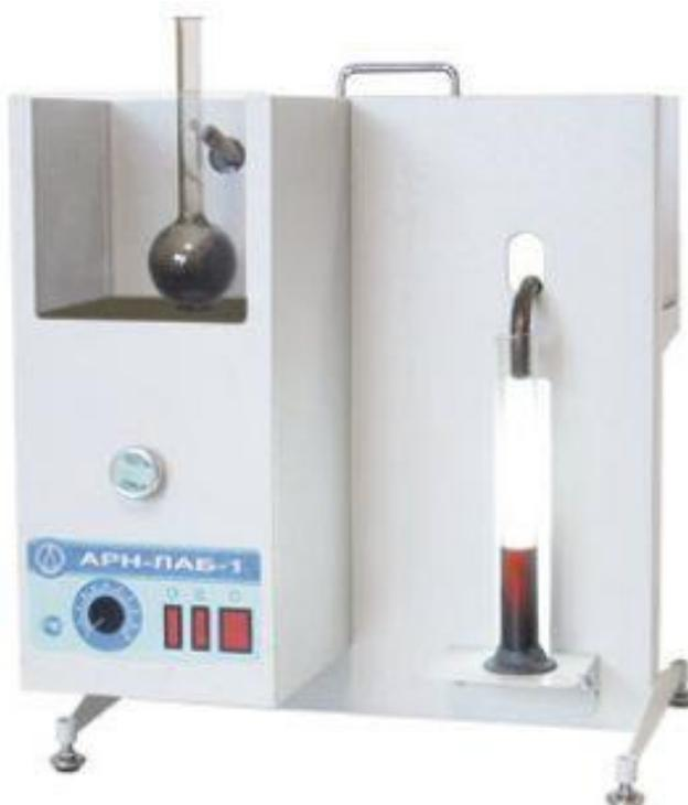
Рис 2. Аппарат для разгонки нефтепродуктов
