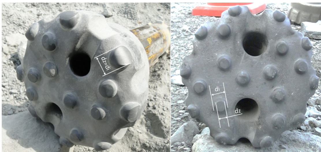
Рис. 6. Оценка абразивного износа буровых долот пневмоударника Fig. 6. Assessment of abrasive wear of pneumatic hammer drill bits
