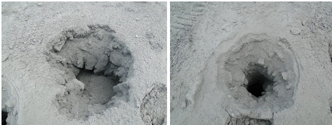
Рис. 19. Потеря и перебуривание взрывных скважин на карьере Борок Fig. 19. Loss and over-drilling of blast holes at the Borok quarry
