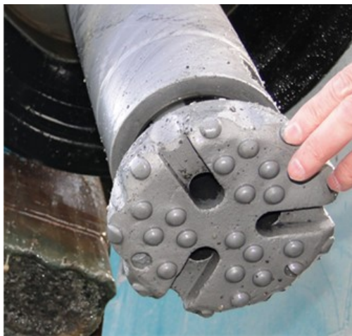
Рис. 15. Изучение износа твердосплавных инденторов после бурения взрывных скважин Fig. 15. Study of hard-alloy indenter wear after drilling of blast holes
