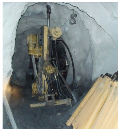
Рис. 13. Буровой станок СБУ-6 с погружным пневмоударником П-155Р Fig. 13. Drilling machine SBU-6 with submersible pneumatic hammer P-155P
