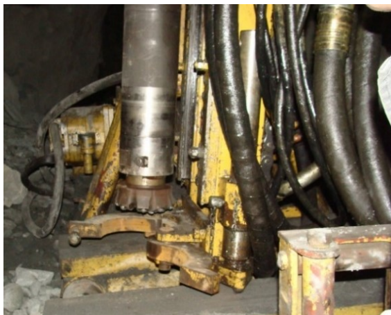
Рис. 13. Буровой станок СБУ-6 с погружным пневмоударником П-155Р Fig. 13. Drilling machine SBU-6 with submersible pneumatic hammer P-155P
