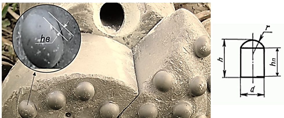
Рис. 7. Оценка абразивного износа матрицы буровых долот пневмоударника Fig. 7. Assessment of abrasive wear of the matrix of pneumatic hammer drill bits
