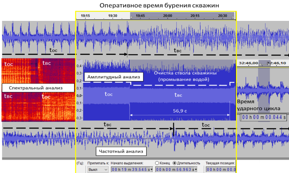
Рис. 16. Определение ресурсных параметров бурового инструмента и пневмоударников Fig. 16. Determination of lifetime parameters of drilling tools and pneumatic hammers
