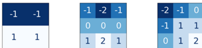
Рис. 29. Получение карт признаков с помощью ядер Fig. 29. Obtaining feature maps using kernels
