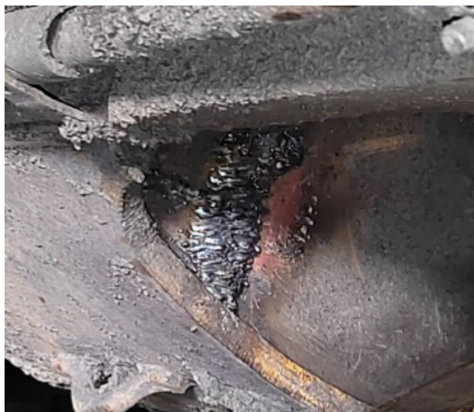
Рис. 2. Трещины в районе крепления первой поперечины к раме
