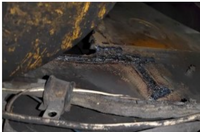
Рис. 1. Трещина на сварном шве в районе крепления тягового генератора Fig. 1. A crack in the weld in the area of the traction generator attachment
