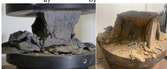
Рис. 7. Характер разрушения при одноосном сжатии образца геополимера в возрасте 60 сут (а) без термической обработки (б) и после обжига при температуре 600°C
