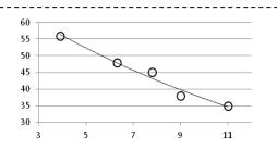
Рис. 2. Зависимость относительного радиуса зоны разрушений (в раиусах скважинного заряда) от крепости пород.
