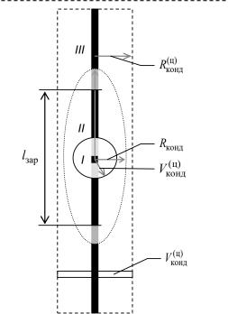
Рис. 1. Схема к расчету объема зоны кондиционного дробления: I, II, III — зоны интенсивного дробления для сосредоточенного, удлиненного и бесконечно длинного зарядов
