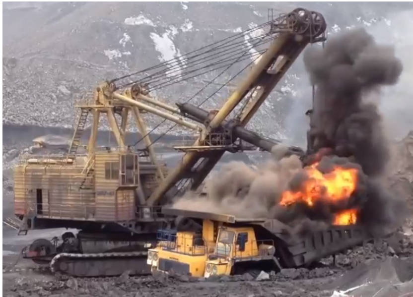
Рис. 3. Режим погрузки легко воспламеняющейся смеси угля и вскрышной породы Fig. 3. Loading mode of a highly flammable mixture of coal and overburden
