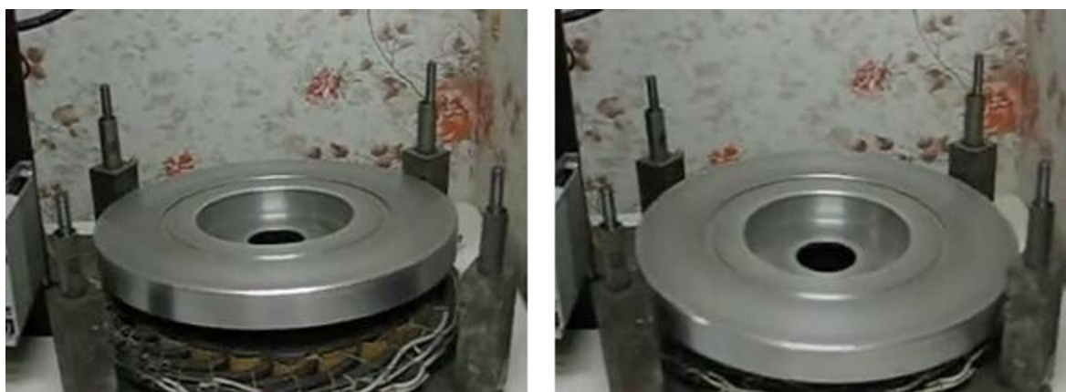
Рис. 2. Демонстрация вращения ротора, параметры которого не соответствуют критерию устойчивости Fig. 2. Demonstration of rotation of a rotor whose parameters do not meet the stability criterion
