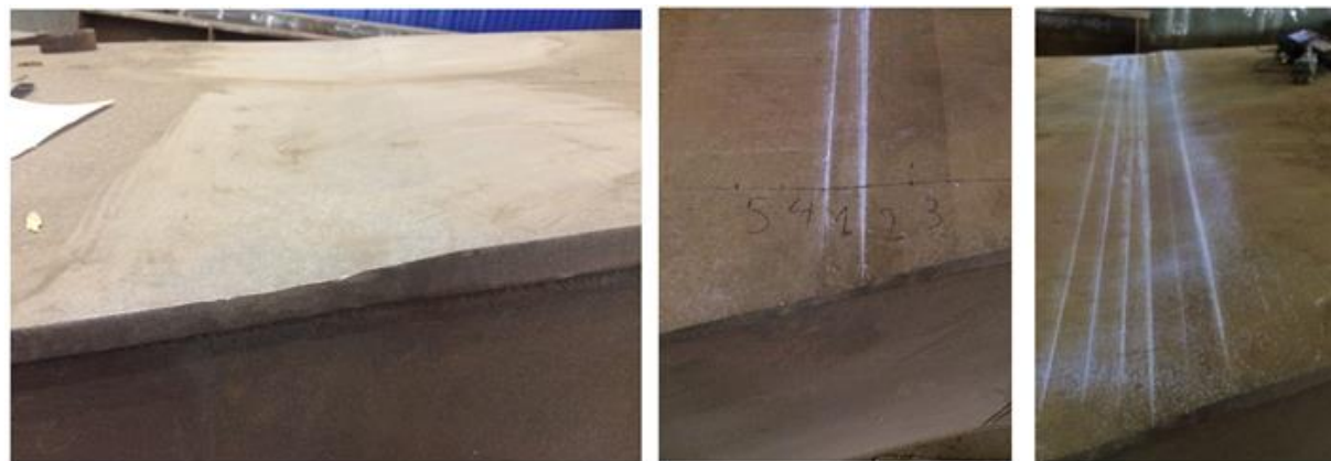
Рис. 2. Разметка для сканирования методом МПМ
