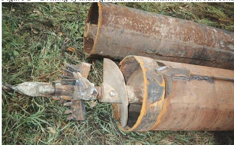
*Рисунок 3 – Расширитель прямого хода со шнековым ставом в секциях колонны инвентарных обсадных труб*
