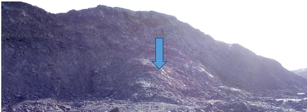
Рисунок 2 – Неразрушенный взрывом целик из-за увеличения сетки скважин, вызванного наличием на поверхности бурового блока разновысотных полок Figure 2 – Unexploded pillar due to the increase in the well grid caused by the presence of different height slopes on the surface of the drilling block
