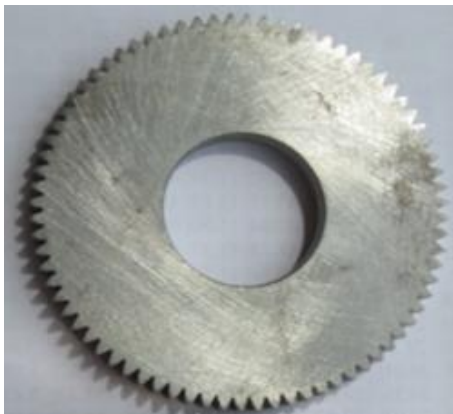
Рис. 5. Многозаходный зубчатый накатник Fig. 5. Multi-start gear knurl
