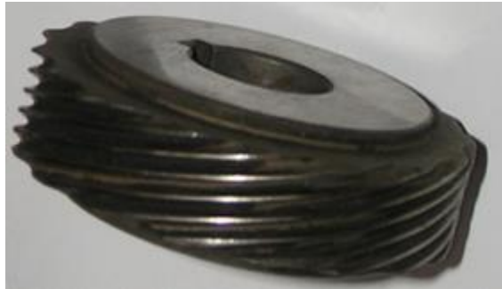
Рис. 5. Многозаходный зубчатый накатник Fig. 5. Multi-start gear knurl
