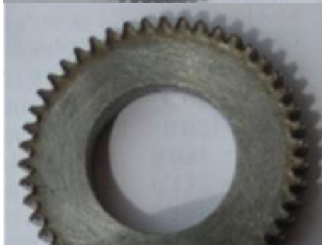
Рис. 6. Накатанные зубчатые колеса Fig. 6. Knurled gears
