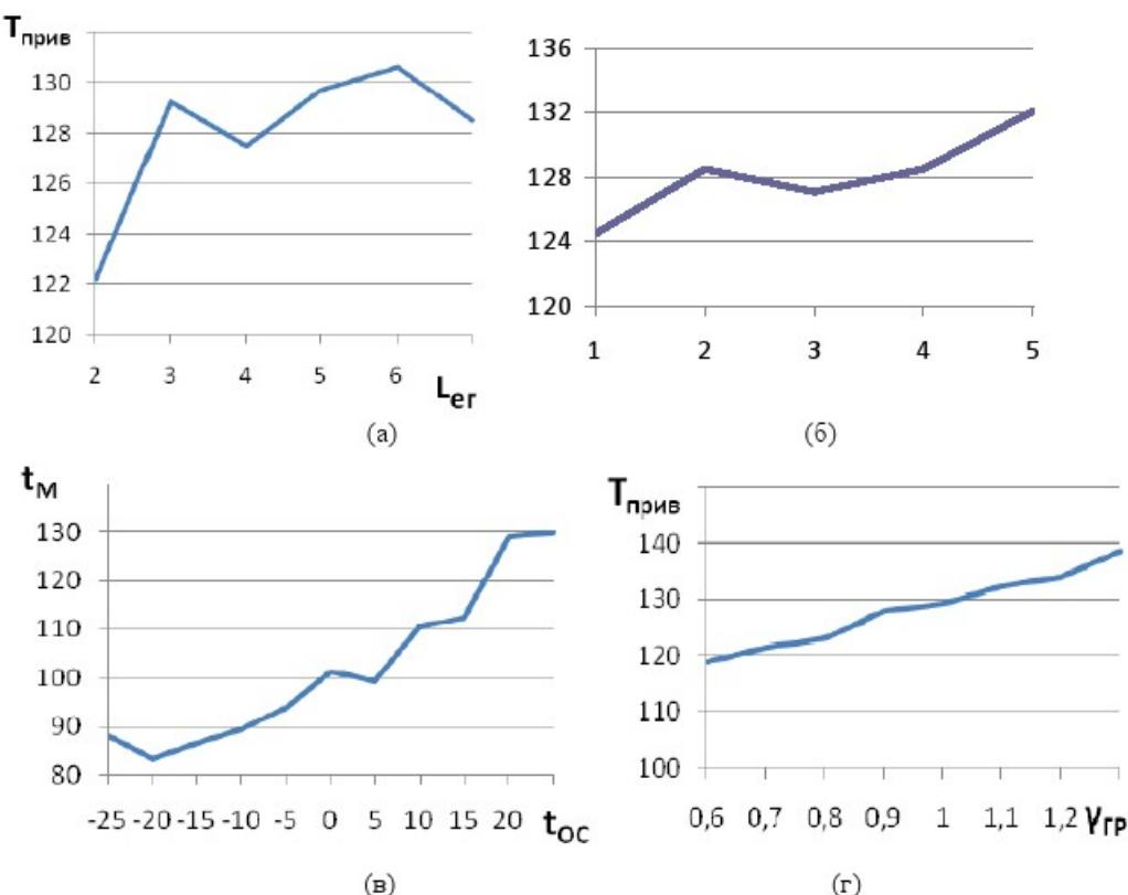
Рис. 1. Графики зависимостей приведенной температуры масла РМК ( $T_{\text{priv}}$ ) от длины груженой ездки (а), уклона (б), коэффициента использования грузоподъемности (в) и температуры масла ( $t_M$ ) от температуры окружающей среды (г).
