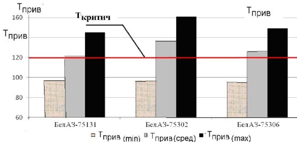
Рис. 2. Величина минимальной, средней и максимальной приведенной температуры ( $T_{priv}$ ) для различных марок автосамосвалов.
