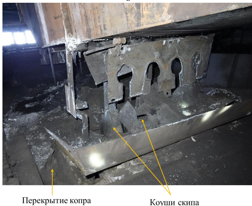
Рис. 2. Положение верхнего пояса скипа при инциденте, вызванном его обрывом а – вид под промежуточной площадкой копра; б – вид над промежуточной площадкой копра
