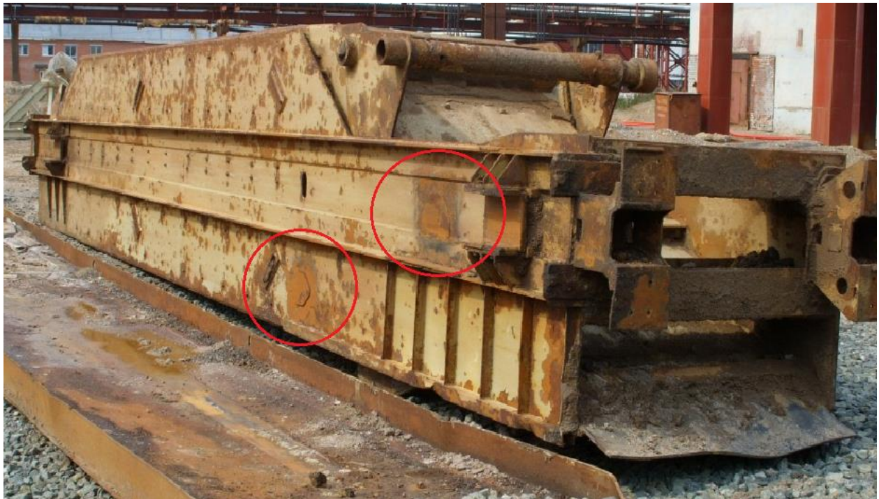
Рис. 6. Фото скипа типа СН после ремонта по завариванию трещин в нижнем поясе
