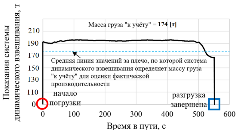
Рис. 8. Измерение показаний системы динамического взвешивания КС БЕЛАЗ-7531 Fig. 8. Dynamic weighing system DT BELAZ-7531 readings measurement
