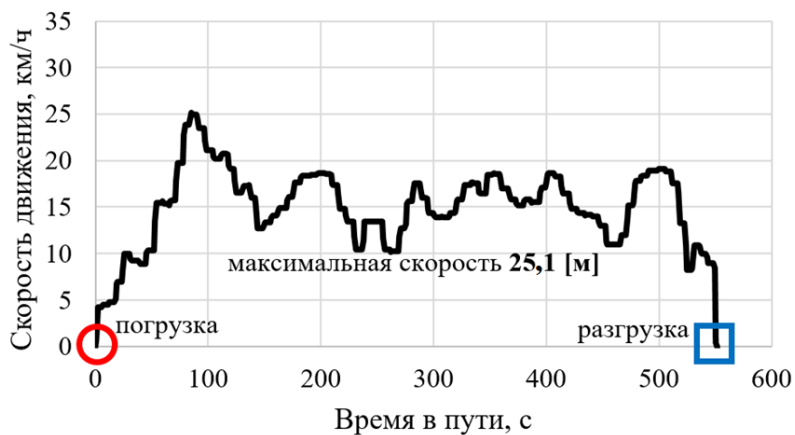
Рис. 7. Изменение скорости КС БЕЛАЗ-7531 Fig. 7. Changing the speed of the DT BELAZ-7531
