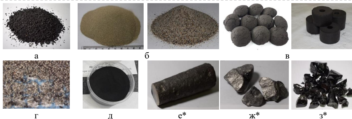
Рис. 2. Продукты подготовительного этапа: а – недожог; б – шлаковый песок; в – топливные брикеты;
