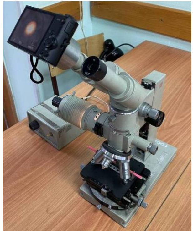
Рис. 3. Стереомикроскоп модели «ЛОМО МЕТАМ Р-1» с закрепленным на нем цифровым фотоаппаратом для получения изображений зерен Fig. 3. Stereo microscope model «LOMO METAM R-1» with a digital camera attached to it for obtaining images of grains
