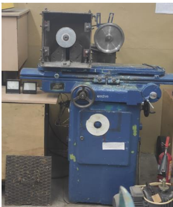
Рис. 11. Стенд для испытаний шлифовальных кругов на механическую прочность Fig. 11. Test stand for grinding wheels for mechanical strength
