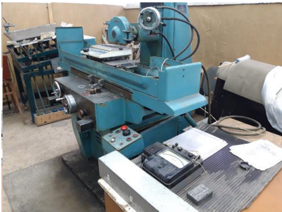
Рис. 12. Плоскошлифовальный станок модели 3Г71 с двухкомпонентным динамометром для испытания опытных кругов Fig. 12. Surface grinding machine model 3G71 with a two-component dynamometer for testing experimental grinding wheels
