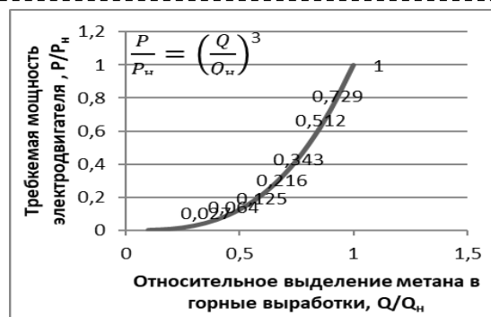
Рис. 2. Изменение мощности электродвигателя при снижении производительности вентилятора Fig. 2. Change in motor power when fan performance decreases
