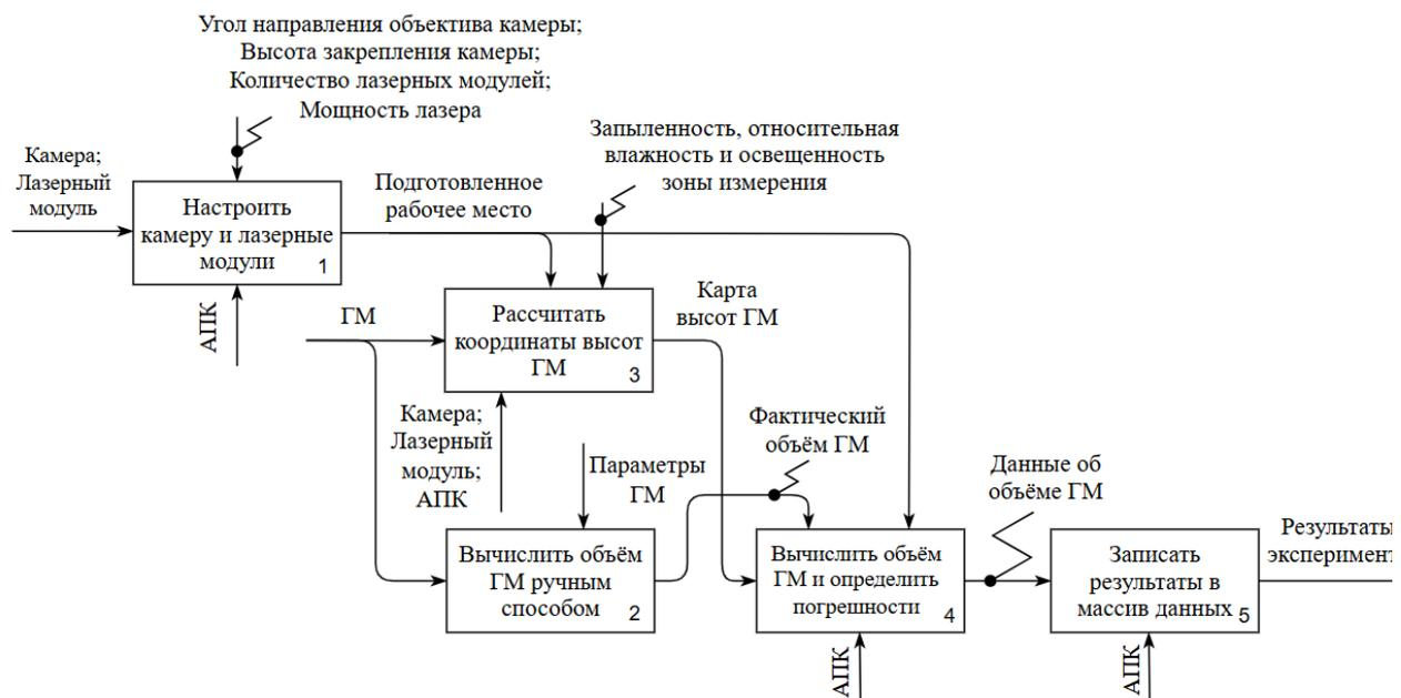
Рис. 4. Проведение экспериментов на стенде по стандарту системно-функционального моделирования IDEF0
