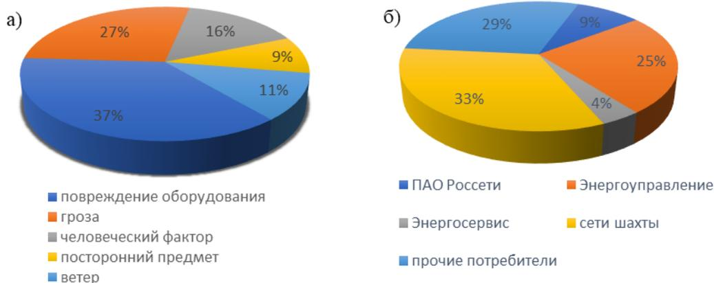
Рис.4. Причины и место аварий систем внешнего электроснабжения шахт
