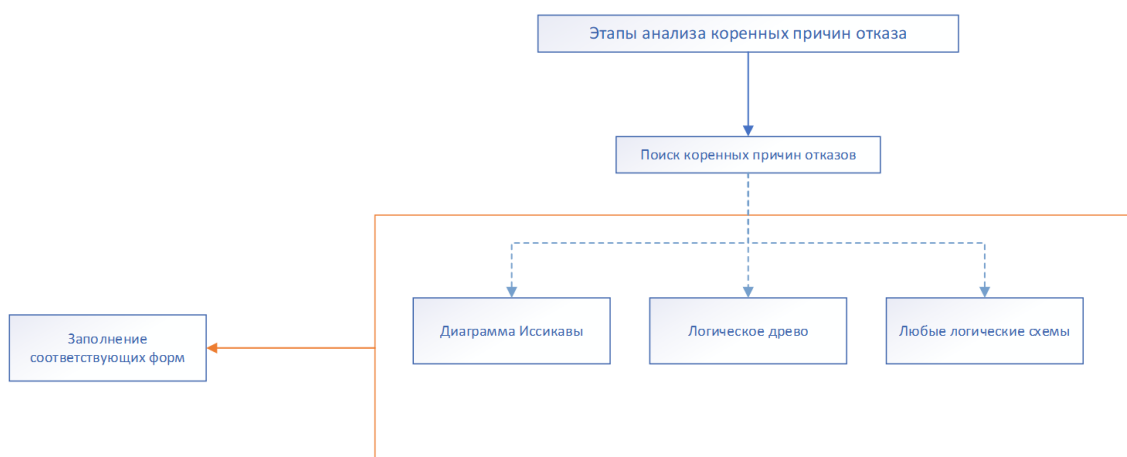
Рис. 5. Блок-схема анализа коренных причин отказа Fig. 5. Block diagram of the analysis of the root causes of failure
