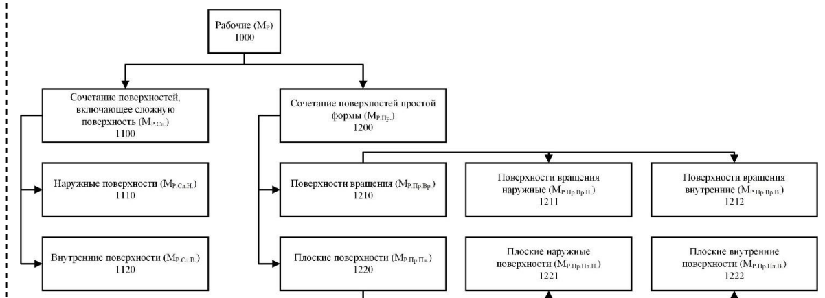
Рис. 3а. Модули рабочих поверхностей ДСЕ Fig. 3a. Modules of working surfaces of parts and assembly units
