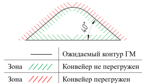
Рис. 7. Пример поперечного сечения ожидаемого контура горной массы на конвейере
