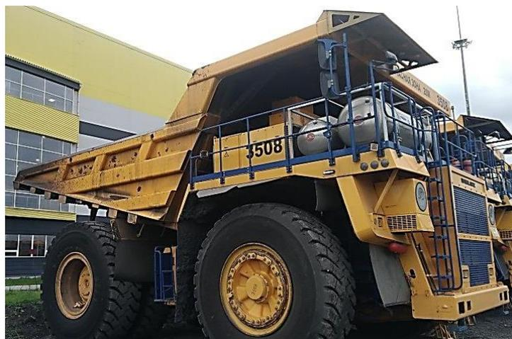
Рис. 2. Расположение криогенного топливного бака на палубе карьерного самосвала БелАЗ-75131
