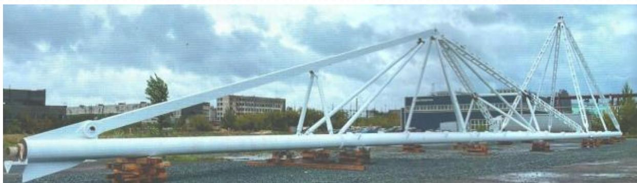
Рис. 6. Контрольная сборка модернизированной стрелы ЭШ-10.0 перед отправкой заказчику
