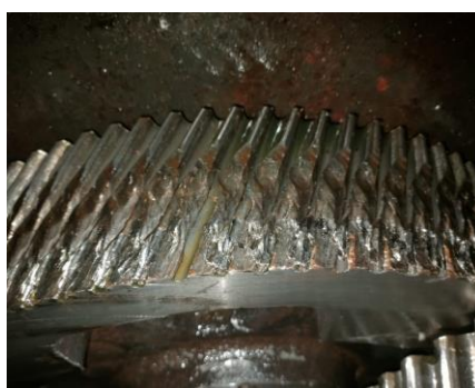
Рис. 1. Поломка редуктора в результате неправильной эксплуатации: а) – поломка быстроходного вала-шестерни полностью; б) – изношенные зубья с одной стороны зубчатого колеса
