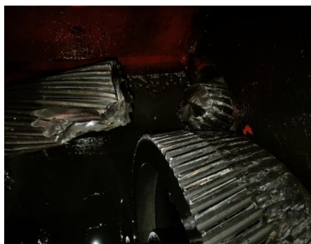
Рис. 1. Поломка редуктора в результате неправильной эксплуатации: а) – поломка быстроходного вала-шестерни полностью; б) – изношенные зубья с одной стороны зубчатого колеса
