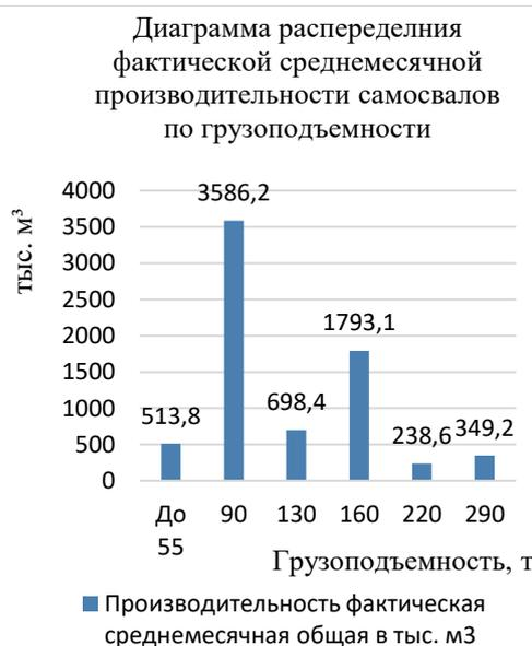
Рис. 5. Распределение фактической среднемесячной производительности самосвалов разной грузоподъемности на восьми разрезах Прокопьевского района
