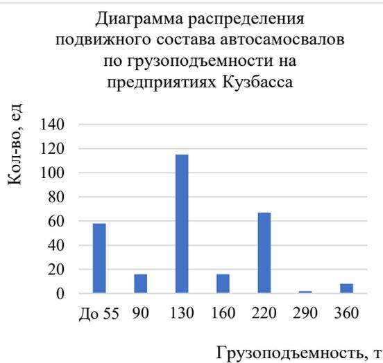
Рис. 1. Количество самосвалов разной грузоподъемности на восьми разрезах Прокопьевского района
