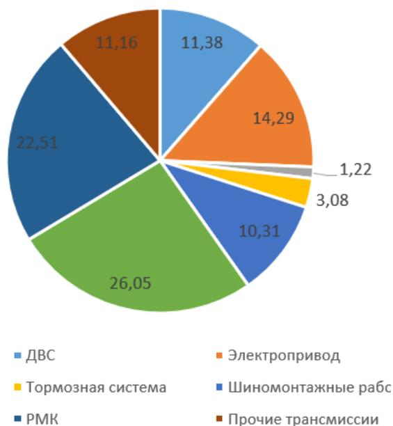
Рис. 6. Диаграмма причин ремонтных простоев карьерных автосамосвалов, %
