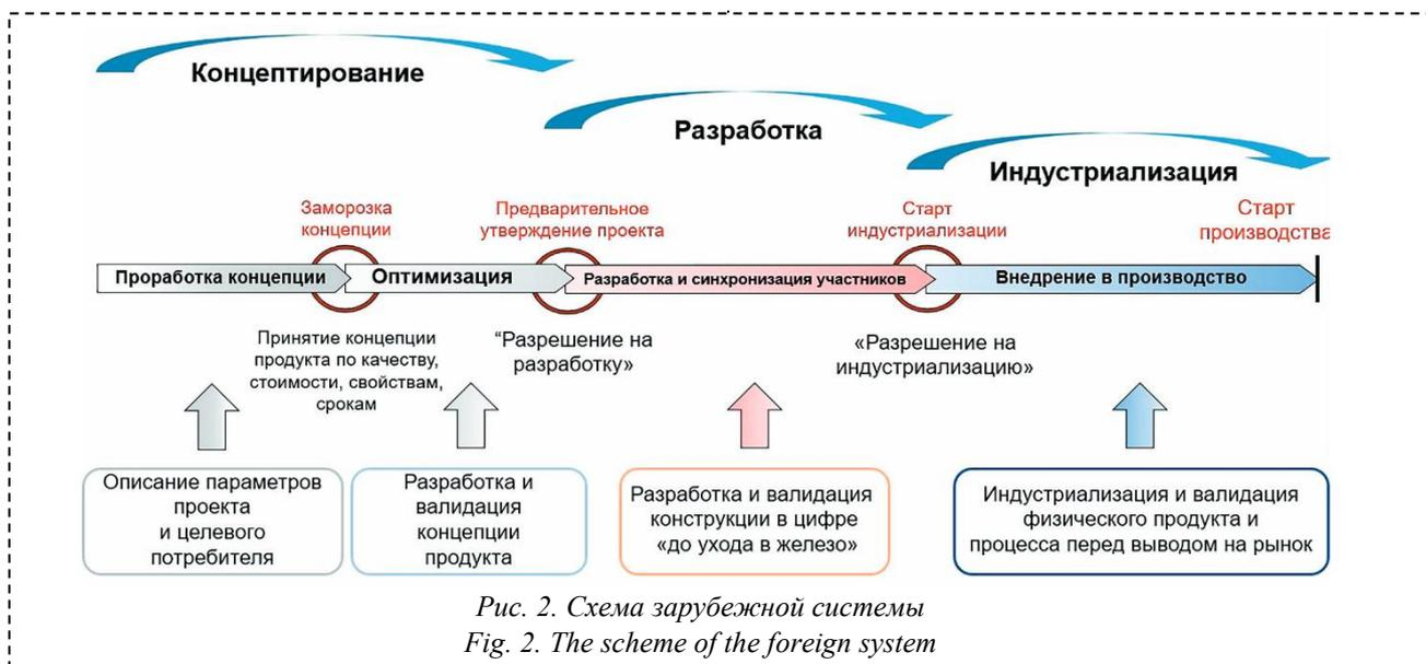
Рис. 2. Схема зарубежной системы
