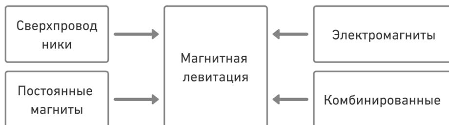
Рис. 1. Способы создания магнитной левитации
