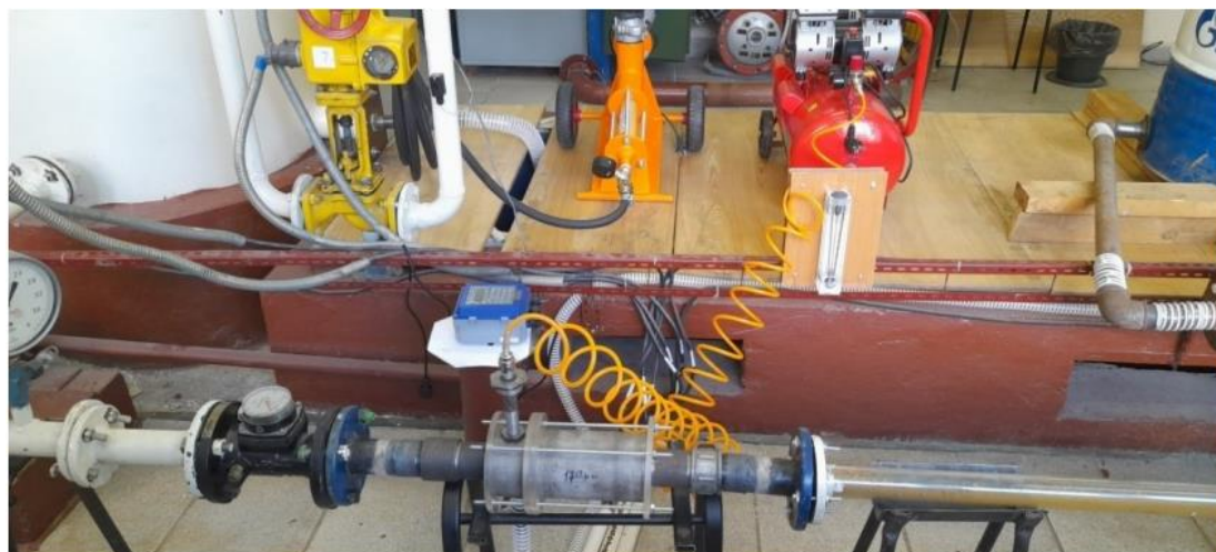
Рис. 8. Узел магистрального аэратора. Фотография выполнена автором в ходе эксперимента Fig. 8. Main aerator assembly. Photograph taken by the author during the experiment
