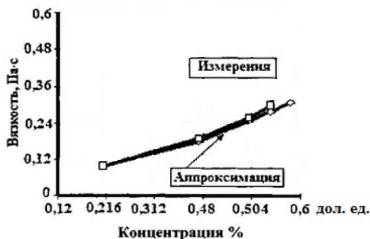
Рис. 5. Зависимость вязкости ( \eta ) гидросмеси от концентрации воздуха в диапазоне 2-5% при концентрации твердого 0,562-0,216% соответственно. Составлено автором
