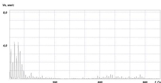
Рис. 1. Ярко выраженное нарушение жесткости опорной системы аспирационной установки
