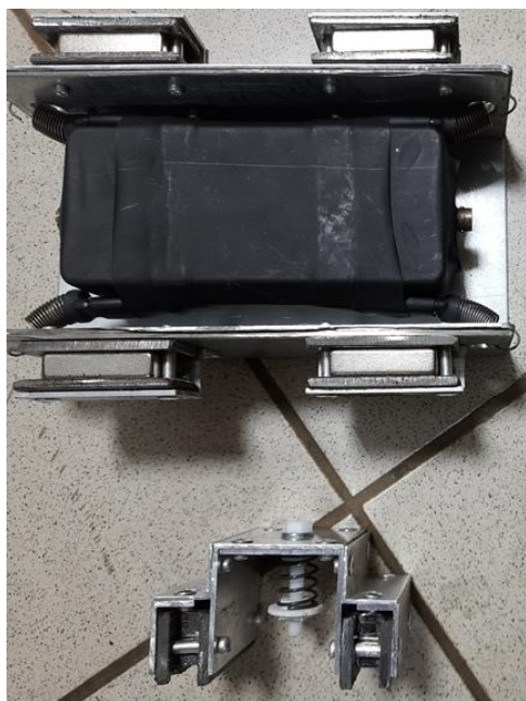
Рис. 6. Магнитные держатели для предусилителей и датчиков
