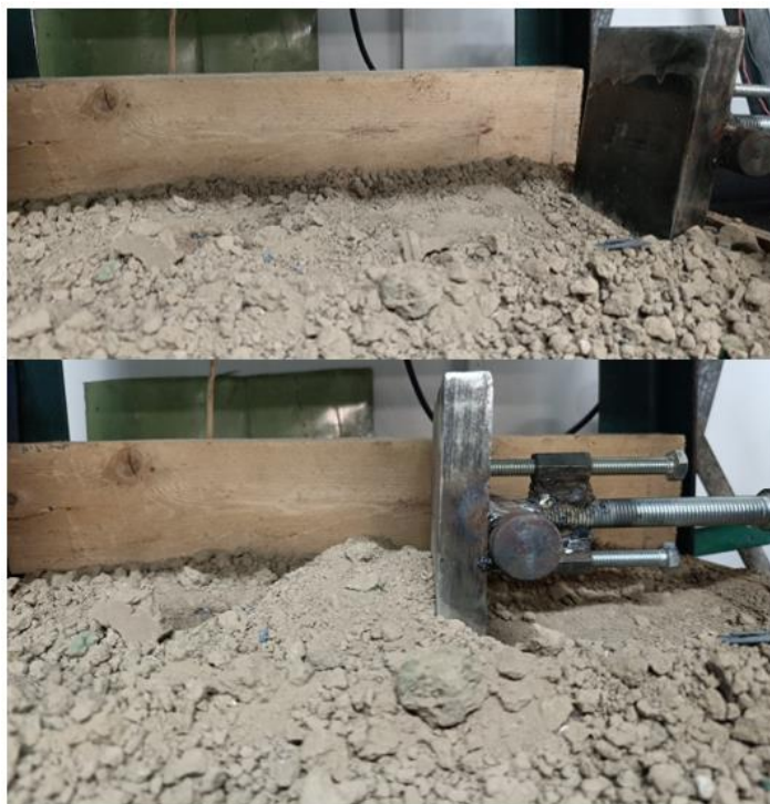
Рис. 6. Стенд для моделирования условий движения бурового става в массиве грунта Fig. 6. A stand for modeling the conditions of movement of a drilling rig in a soil mass
