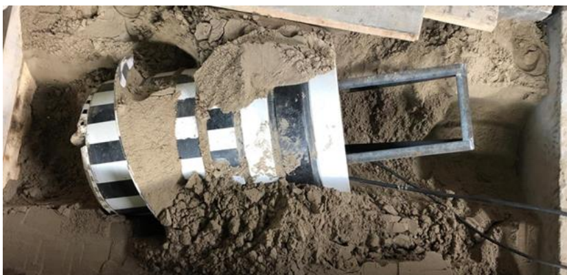
Рис. 5. Испытания демонстрационного образца геохода Fig. 5. Testing of a prototype geohod in loose soil
