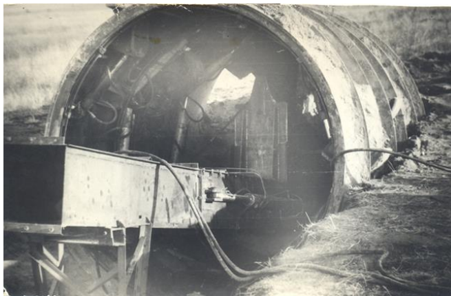
Рис. 2. Натурные испытания ВПА «ЭЛАНГ-3» Fig. 2. Field tests of the first sample of the geohod
