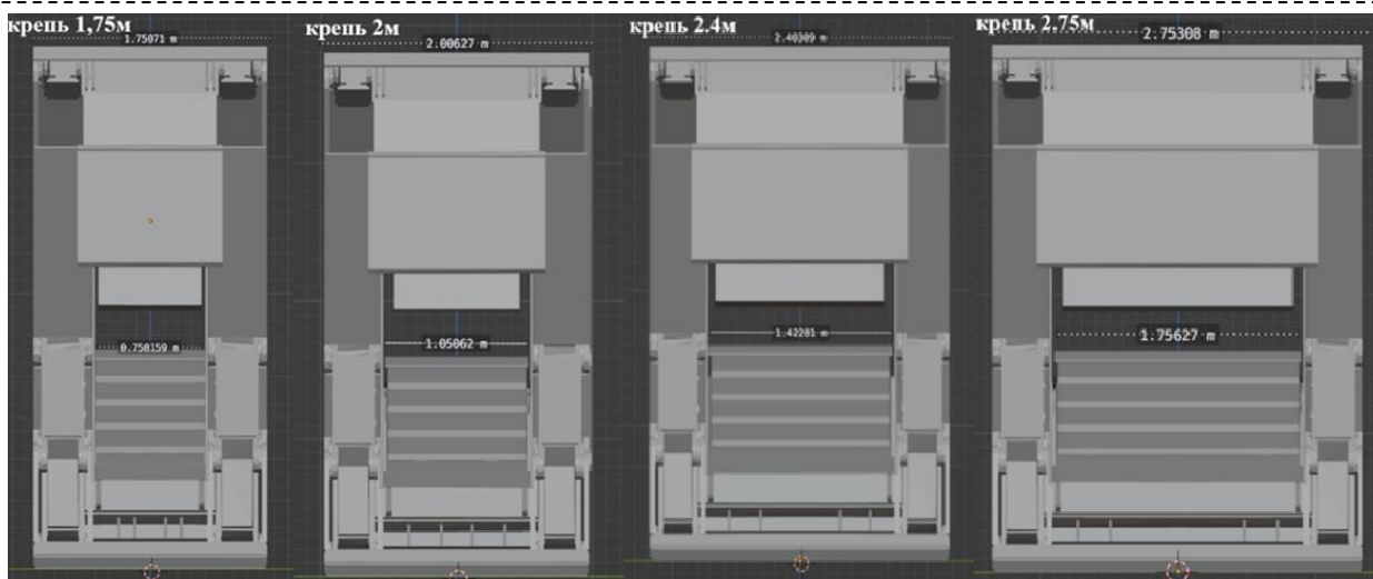
Рис. 2. Варианты крепей с шириной выпускного окна 0.75 м, 1 м, 1.4 м и 1.75 м
