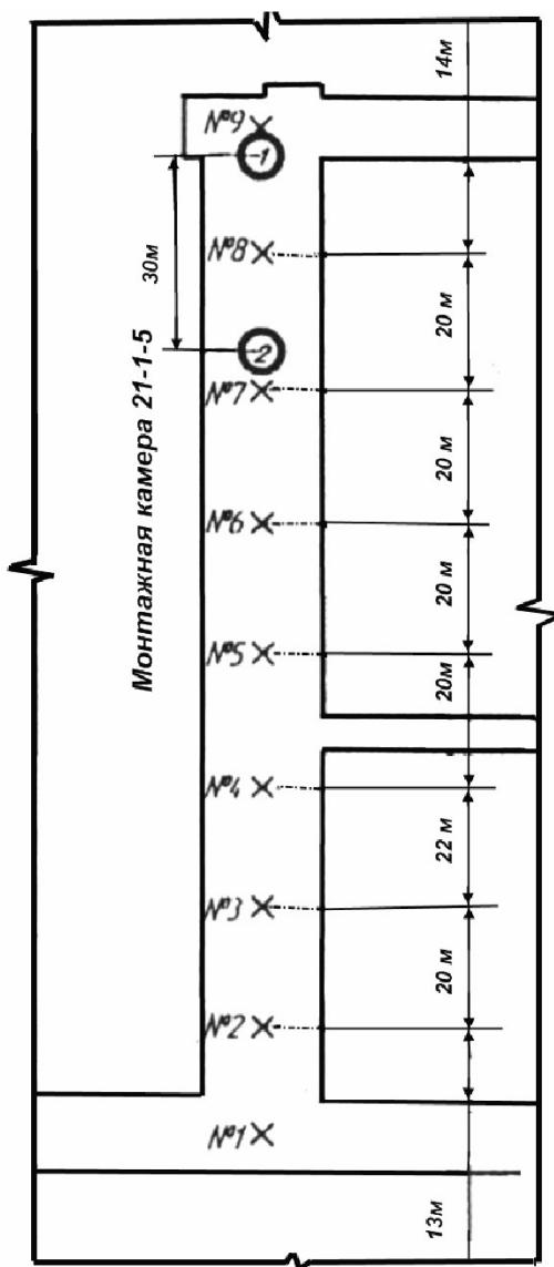
Рис. 2. Схема расположения наблюдательных станций в монтажной камере 21-1-5
