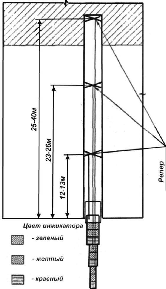
Рис. 3. Схема установки цветного индикатора РГ-4
