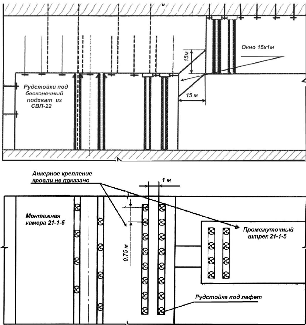
*Rис. 1. Сопряжение монтажной камеры 21-1-5 с промежуточным штревком*
