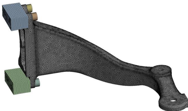
Рис. 4. Общий вид конечно-элементной модели несущего рычага мехатронной трансмиссии «ZF»
