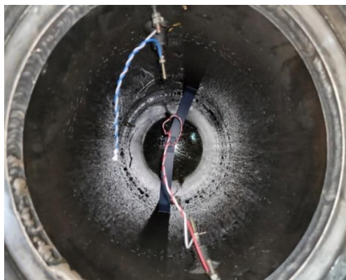
Рис. 3. Внешний вид нижней части рабочей камеры испытательного оборудования с помещенным раствором гидроперита с пробой нефтепродукта и установленным капсюль-детонатором на границе раздела фаз масло/вода и датчиком детонации
