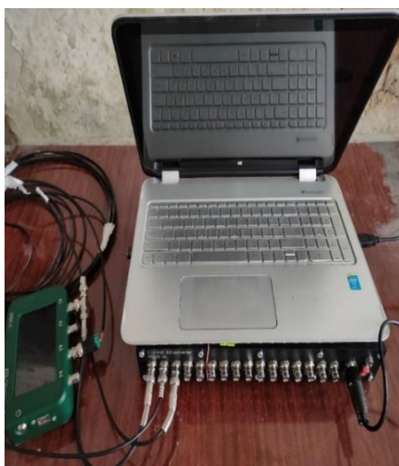
Рис. 6. Внешний вид подключенных линий с датчиков к измерительному оборудованию (АЦП, ИВИ-4)
