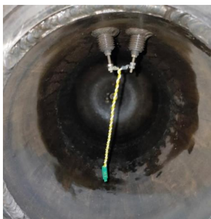
Рис. 4. Внешний вид верхней части рабочей камеры испытательного оборудования с установленным низкоинерционным резистивным датчиком температуры Fig. 4. Exterior view of the upper part of the working chamber of the test equipment with a low-inertia resistive temperature sensor installed
