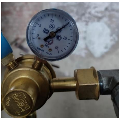
Рис. 5. Внешний вид манометра (позиция 6, Рис. 2) при создании давления 150 атм. в рабочей камере испытательного оборудования
