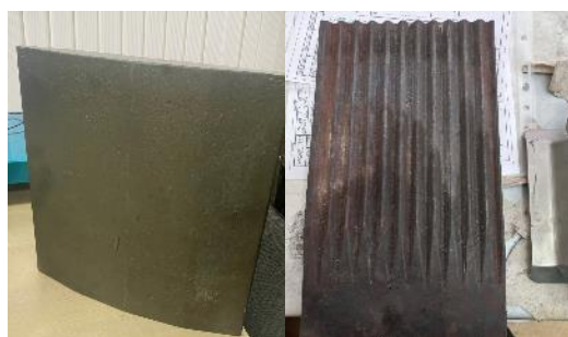
Рис. 2. Вид брони экспериментальных дробилок (плоская и зубчатая) Fig. 2. View of armor of experimental crushers (flat and toothed)
