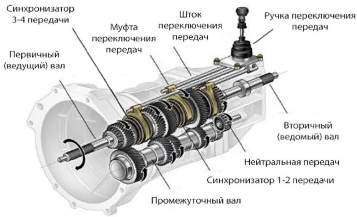
Рис. 5. Устройство механической КПП автомобиля
