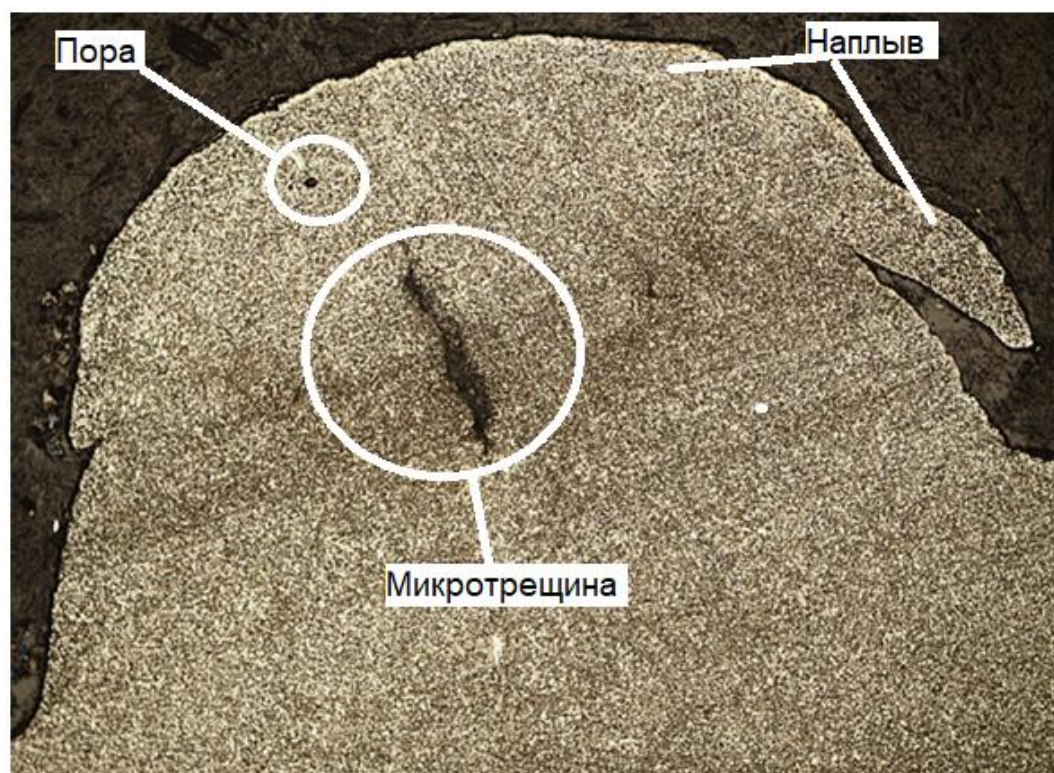
Рис. 6. Дефекты образца №6 (наплыв, микротрещина и пора)
