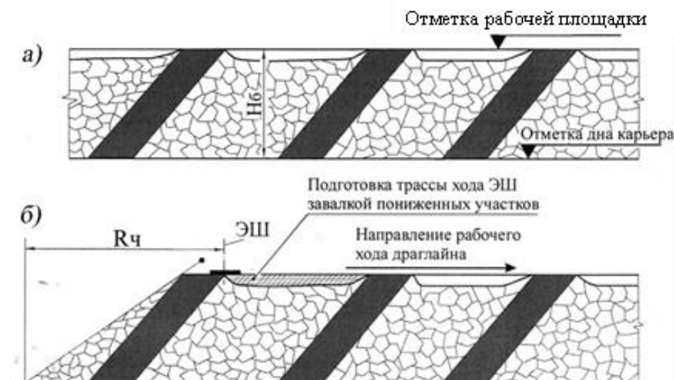
Рисунок 3 – Продольный разрез развала породугольного забоя (а) и положение экскаватора перед началом добычных работ с подготовкой трассы хода (б) Figure 3 – Longitudinal section of the rock-coal cut (a) and the position of the excavator before the start of mining operations with preparation of the stroke path (b)
