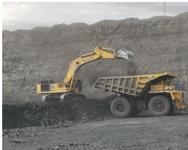
Рис. 2. Пример неудовлетворительного уровня квалификации машиниста по показателю «Угол поворота рабочей платформы» Fig. 2. Example of an unsatisfactory operator qualification level for the "Working platform rotation angle" indicator
