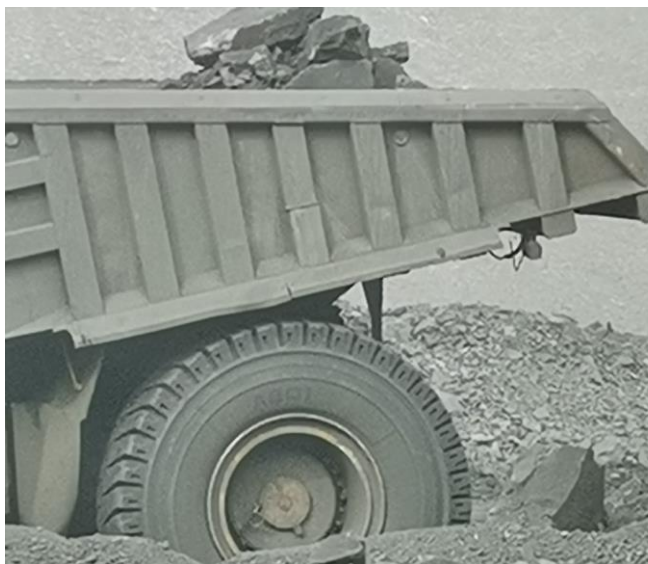
Рис. 3. Пример неудовлетворительного уровня квалификации машиниста по показателю «Полнота наполнения кузова автосамосвала» Fig. 3. Example of an unsatisfactory driver qualification level for the "Dump truck body filling level" indicator
