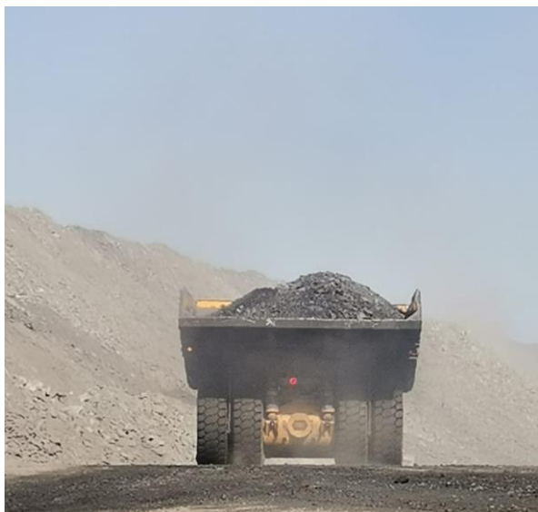
Рис. 3. Пример неудовлетворительного уровня квалификации машиниста по показателю «Полнота наполнения кузова автосамосвала» Fig. 3. Example of an unsatisfactory driver qualification level for the "Dump truck body filling level" indicator
